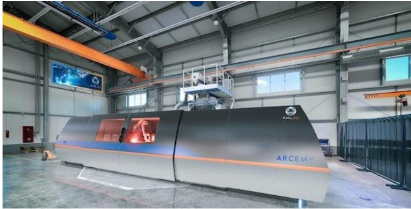
图 14 AML3D 的大幅面增材制造系统 ARCEMY X-Edition 6700
