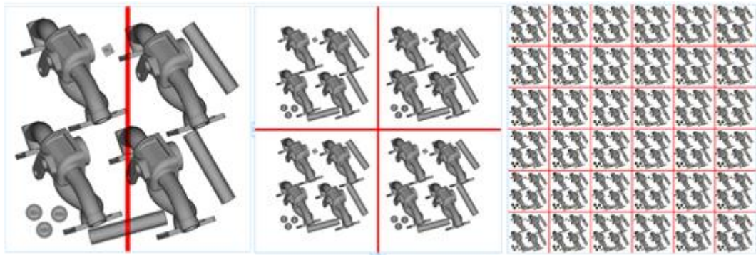
图6 超大尺寸、超多激光装备具备小尺寸零件批量打印潜力
